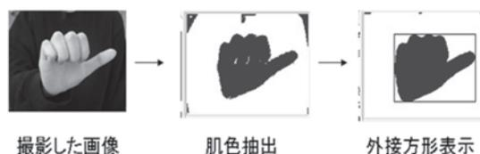
図3. 画像処理プロセスの例
